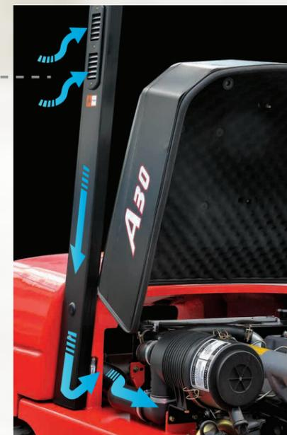
● 发动机进气管采用高位独立通道，有效防止灰尘吸入。
