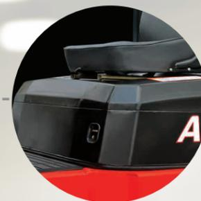
● 整体式发动机机罩及配置安全锁扣。
