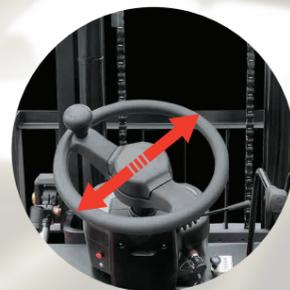
● 采用直径较小方向盘，减少了操作员的疲劳强度。
