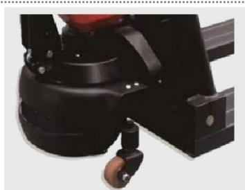
便捷的急停开关设计，比传统的急停开关零件少，结构简单更可靠
