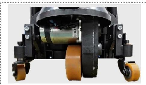
驱动轮防护设计，有效的保护操作人员防止压脚操作更安全
